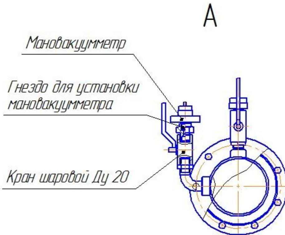
Рисунок 3 - Схема установки измерительных приборов
