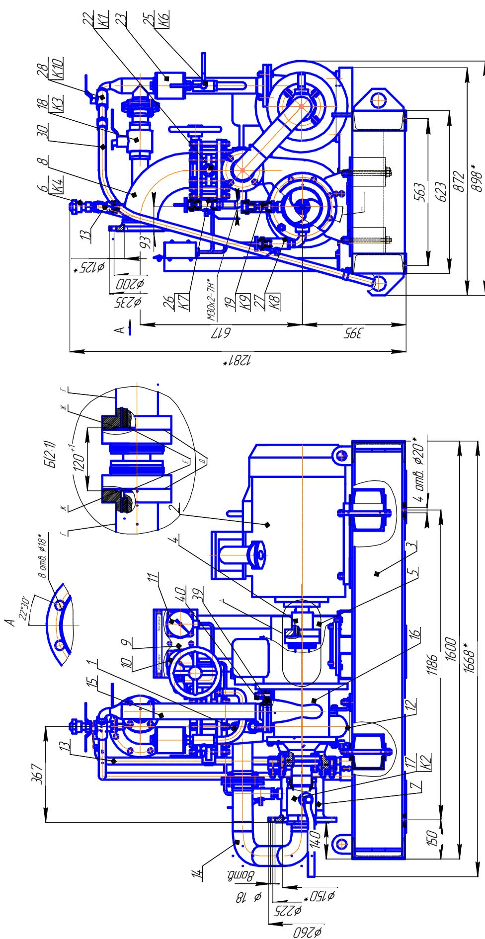
1-насос; 2-электродвигатель; 3-рама; 4-муфта; 5-кожух; 6-клапан запорный; 7-переходник всасывающий; 8-патрубок напорный; 9-щит КИП; 10-мановакуум-метр; 11-манометр; 12-пробка; 13-трубопровод дренажа; 14-трубопровод всасывающий; 15-трубопровод напорный; 16-насос всасывающий; 17-кран шаровой Ду 50; 18-кран шаровой Ду 20; 22-затвор дисковый; 23-бачок; 25, 26, 27, 28-краны шаровые Ду 20; 30-трубопровод шаровые Ду 20; 39-гильза для установки термометра; 40-термометр.
